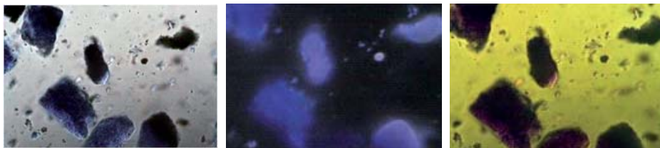
36. ábra Szintetikus ultramarinkék (első gyártási idő 1828) mikrofotográfia, 1000x. Normál, polarizált és kék fényű áteső megvilágításban készült felvételen. A minta a festmény középső területéből kiemelve.
